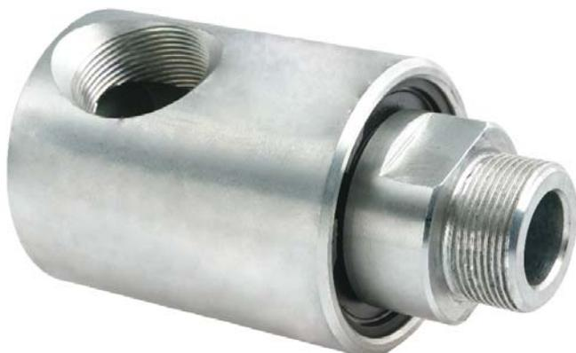
Los embragues y frenos neumáticos de nuestra producción se alimentan con aire a través del eje giratorio sobre el cual van montados. Para ello necesitan una junta rotativa dispuesta en el mismo árbol en forma coaxial. La función de la junta rotativa es, entonces, la de permitir el pasaje de aire entre una parte inmóvil (la manguera de alimentación) y una rotativa (el eje).
