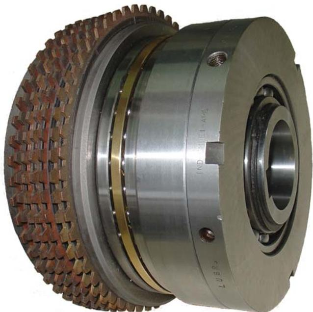
Estos embragues hidráulicos multidisco no requieren regulación, cualidad muy importante ya que en ningún momento necesitan ajustes, pudiendo, en consecuencia, colocarse en lugares inaccesibles. Pueden trabajar en seco y con lubricación por goteo, o forzada por el interior del eje, permitiendo en este caso una gran frecuencia de maniobra.
