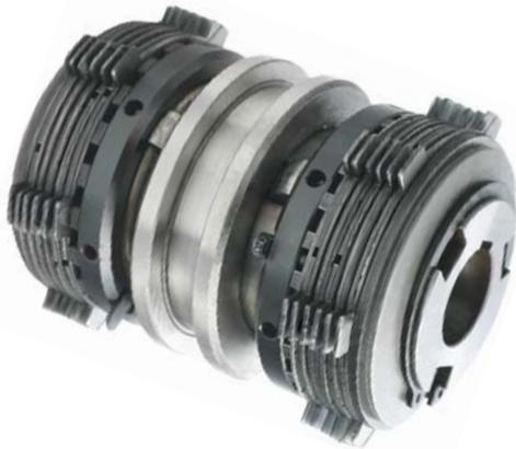
El acoplamiento se produce accionando sobre un collar de empuje, el cual actúa sobre tres levas de bloqueo, cortas y rígidas con una relación aproximada de 1:2,5 produciendo un acople suave y seguro, permitiendo obtener una separación completa entre los discos al retomar la posición libre.
