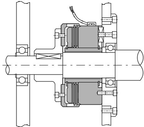
Freno electromagnético multidisco tipo FEM, montado sobre la tapa de rodamiento entre dos tabiques de máquina.
