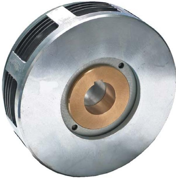
Los frenos electromagnéticos multidisco tipo FSC están diseñados para trabajar en seco o en baño de aceite. Dependiendo de las exigencias de la aplicación se pueden suministrar discos exteriores con ferodo para trabajar en seco (TIPO F) y con bronce sinterizado para trabajar lubricado o en seco (TIPO S).
